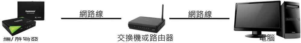
2. 通過網路線直接連接，需修改鍵盤/ 電腦 IP 位址且設定相同網段
